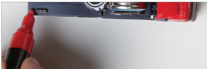
Abb. 13: Polung der Ladebuchse markieren, Fahrzeuggehäuse innen
