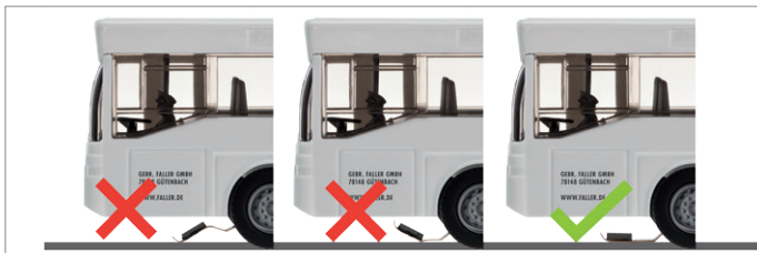
Abb. 51: Einstellung des Lenkschleifers
