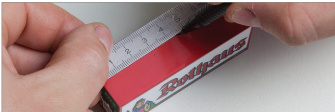
Abb. 35: Position der Ultraschallkapsel ermitteln: Abmessung am Fahrzeugaufbau
