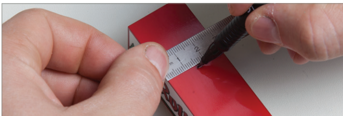
Abb. 36: Position der Ultraschallkapsel anzeichnen
