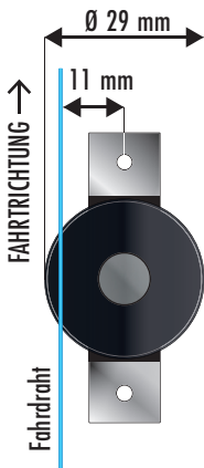
Abb. 9: Stopp-Stelle mit Fahrdraht, Draufsicht
