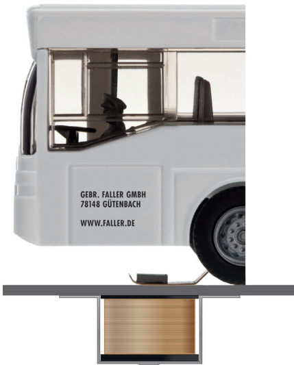
Abb. 11: Süd oben: Im Analogbetrieb falsche Polung. Im Digitalbetrieb Abruf der Langsam- fahrstufe.
