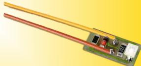
**Platine mit zwei LEDs für Hausbeleuchtung:**
