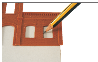
3. Zeichnen Sie auf einem mindestens 1 mm dicken Karton die Innenmaße des Fensters auf und schneiden den Grundriss mit einem Bastelmesser aus. Draw the internal measurements on a cardboard minimum 1 mm depth required. Cut the window ground plot with cutter.
