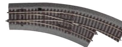
Curved turnout right BWr 2/3 for manual operation. Radius of the main track and the branch track 358mm (R2)/30 deg. With bedding. Matching electric drive: 42620 or 42624. / Aiguillage en courbe droite BWr 2/3 avec entraînement à la main. Rayon de la voie mère et de la voie de déviation: 358 mm (R2) / 30°. Avec ballast. Entraînement électrique adéquat: 42620 ou 42624.
