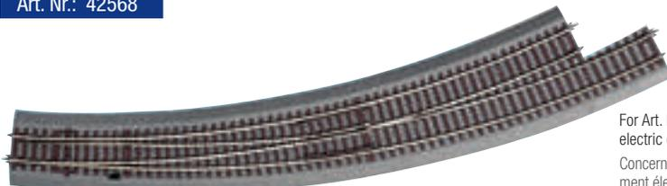
Curved turnout left BWI 9/10 for manual operation, radius of the main track and the branch track 826.4mm (R9)/30 deg. / Aiguillage en courbe gauche BWI 9/10 avec entraînement à la main, rayon de la voie mère et de la déviation : 826.4 mm (R9) / 30°.
