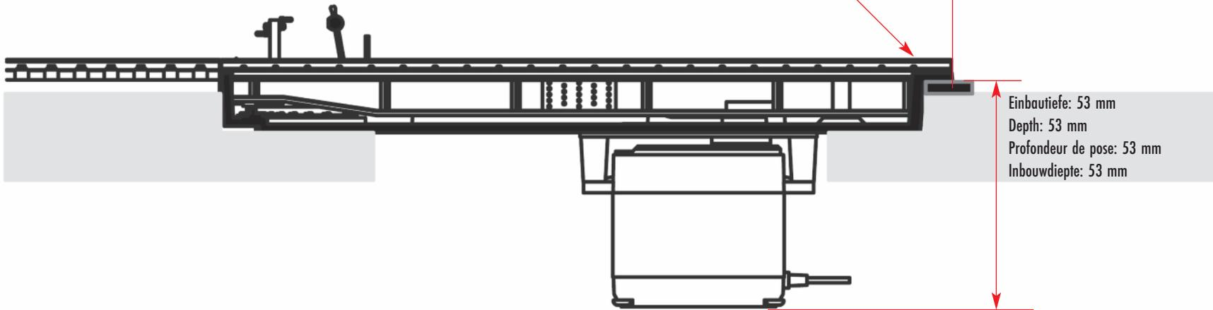
Stellen Sie den Servo bzw. die Drehscheibenbühne über die Servosteuerung 180725 so ein, dass die Gleise in den Endpositionen in einer Flucht liegen.
