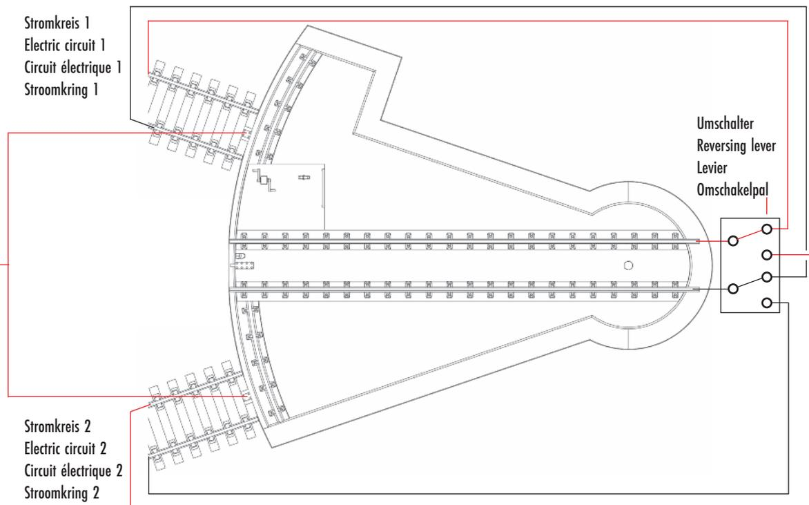
Beim Anfahren eines anderen Stromkreises müssen gleichzeitig die Gleisanschlüsse der Drehscheibenbühne umgeschaltet werden.
