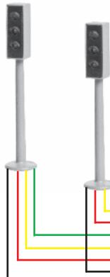
Anschluss direkt an eine Traffic-Light-Control (Art.Nr.: 161654).
