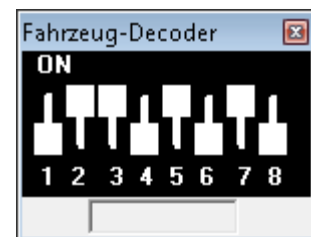
Abb. 4.16 Darstellung der Mikroschalter einer Märklin-Lok
