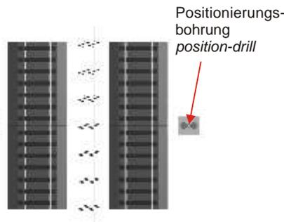
3. Markieren Sie mit Hilfe eines Stiftes oder einer Spitze die Schraubenpositionen. Anschließend entfernen Sie die Grundträger und stechen bzw. bohren mit einem  $\text{Æ}1,2 \text{ mm}$  Bohrer die ermittelten Positionen vor.
