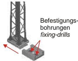
2. Positionieren Sie die Grundträger an den gewünschten Stellen auf Ihrer Anlage. Der richtige Abstand zur Gleismitte kann mit Hilfe der Mastpositionslehre 4397 bestimmt werden.
