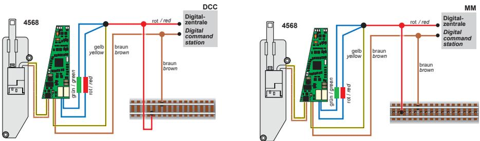
Anschluss nach Adressprogrammierung für invertierte Stellrichtung!
