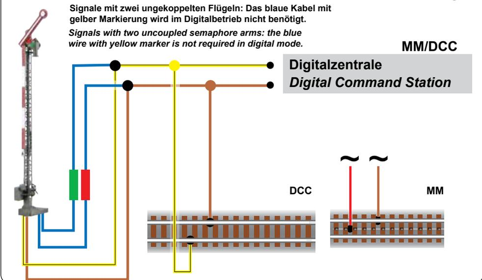
5. Senden Sie mit der Digitalzentrale nun für die gewünschte DCC-Adresse einen Schaltbefehl. Der Signalantrieb empfängt den Befehl, registriert die Adresse und quittiert dies durch Umschalten.
