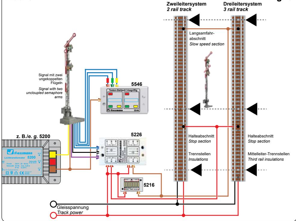
**Fig. 9****4.11 Stellungsrückmeldung per RailCom**
