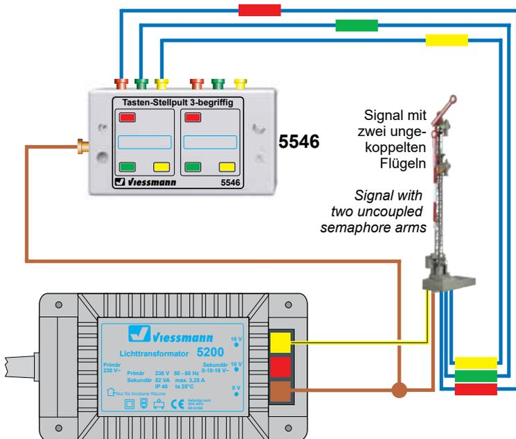
2. Verbinden Sie nur die **rot markierte Steuerleitung** und die Stromversorgungsleitungen des Signalantriebs (braun und gelb, s. Abb. 6) mit dem Gleis – also nur 3 Kabel!
