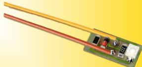
**Platine mit zwei LEDs für Hausbeleuchtung:**
